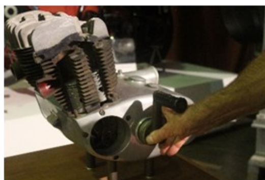
Prototype unique d'un moteur de moto deux temps incluant deux pistons par cylindre Photo MA / IMG 7357
